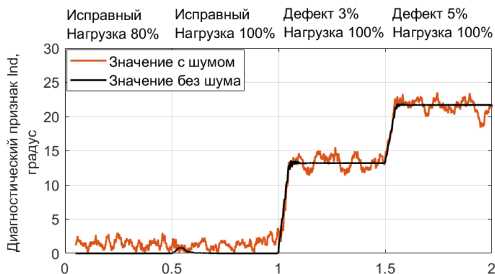
Рисунок 2.7 – Диагностический признак межвитковых замыканий для всех режимов АД
