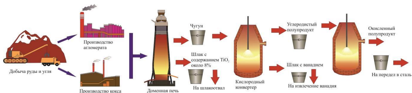
Рис. 1.1. Схема переработки «доменная печь – кислородный конвертер».
