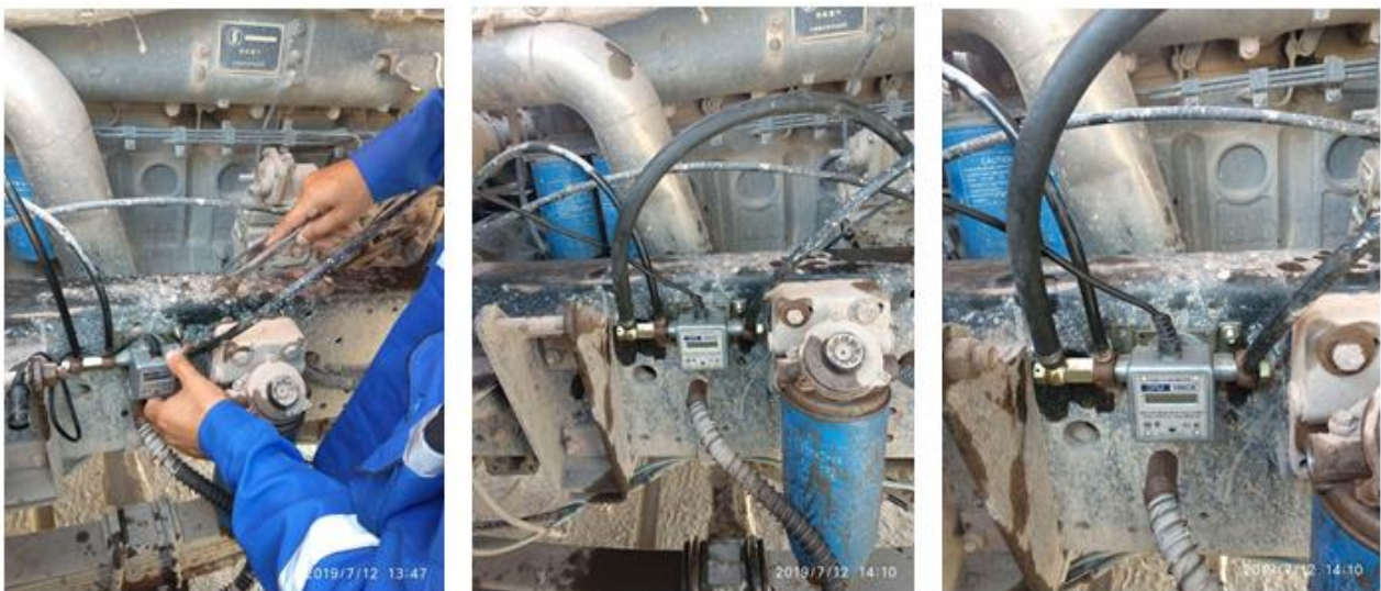
Рисунок 8 – Подключение расходомера топлива DFM в топливную систему автомобиля
