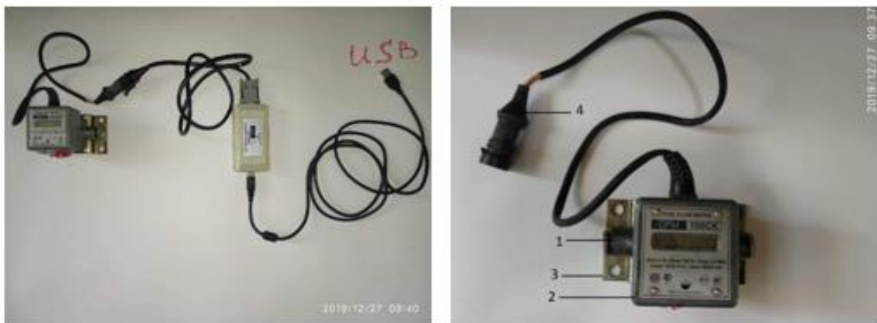
Рисунок 9 – Расходомер топлива DFM: 1 – измерительная камера кольцевого типа; 2 – верхняя крышка с находящейся внутри микропроцессорной платой; 3 – кронштейн; 4 – интерфейсный кабель с разъемом подключения
