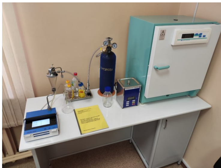
Рисунок 2.1 – Лаборатория чистоты на базе прибора контроля чистоты жидкости ПКЖ-904А [73]
