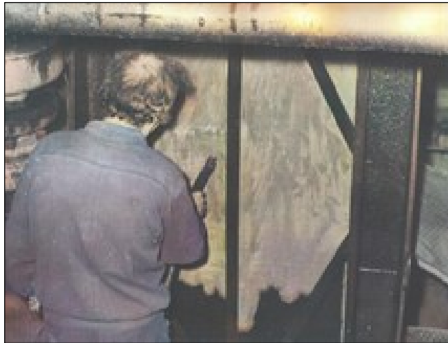
Рисунок 3.11 – Очистка загрязненного фильтра с фильтрующей перегородкой из полиамидной ткани струей сжатого воздуха
