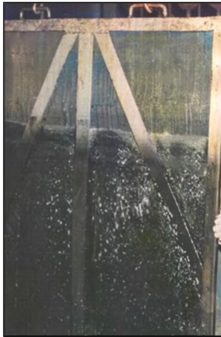
Рисунок 3.9 – Загрязненный фильтр с фильтрующей перегородкой из полиамидной ткани
