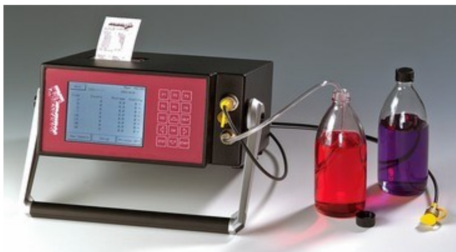
Рисунок 1.6 – Анализатор промышленной чистоты жидкостей PAMAS S-40 [3]
