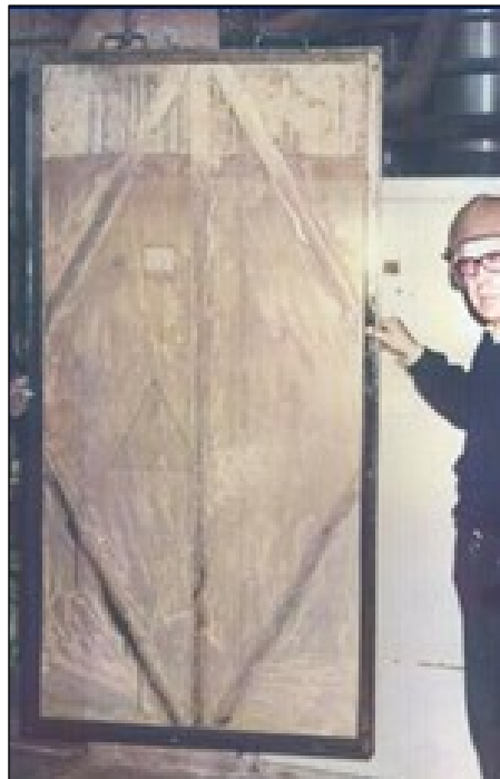
Рисунок 3.10 – Фильтр с фильтрующей перегородкой из полиамидной ткани после продувки сжатым воздухом
