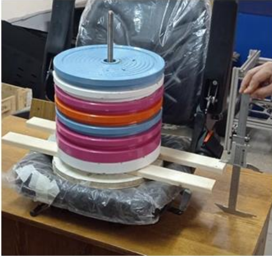
Рисунок 2.4 – Исследование жесткости подушки сидения
