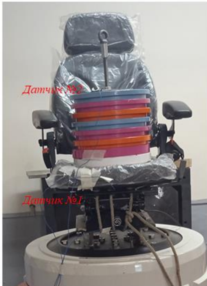
Рисунок 2.6 – Установка сиденья на вибростенде
