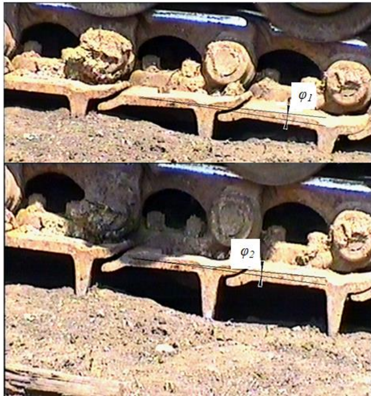
Рисунок 3.9 – Пример определения относительного угла поворота траков (эксперимент Д. В. Хрипунова) [65].
