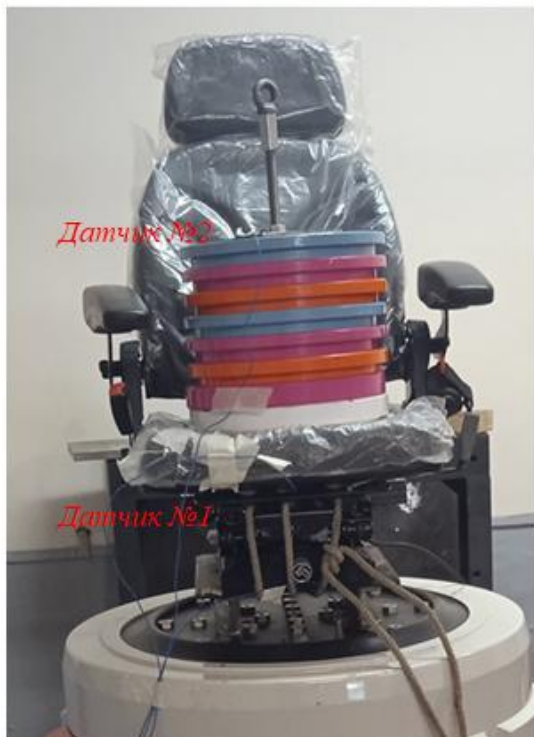
Рисунок 2 – Установка сиденья на вибростенде
