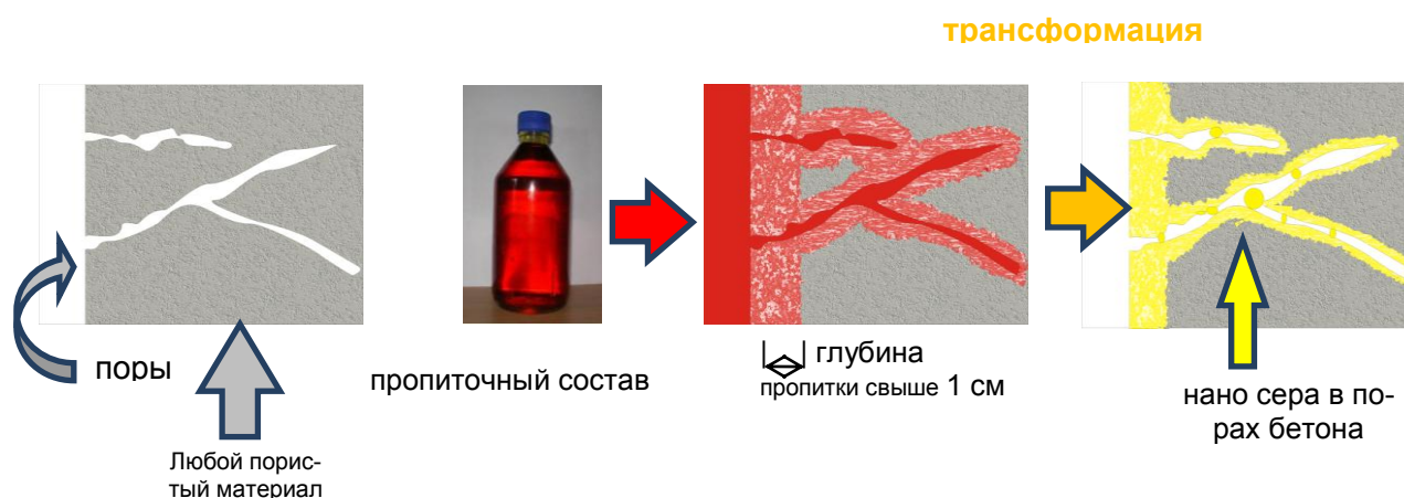
Рис. 5.1.2. Процесс обработки пропиточным составом
