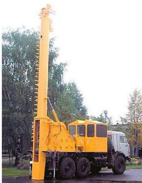
Рисунок 1.17 – Установка МЛ-139 на шасси КАМАЗ-43118 [119]
