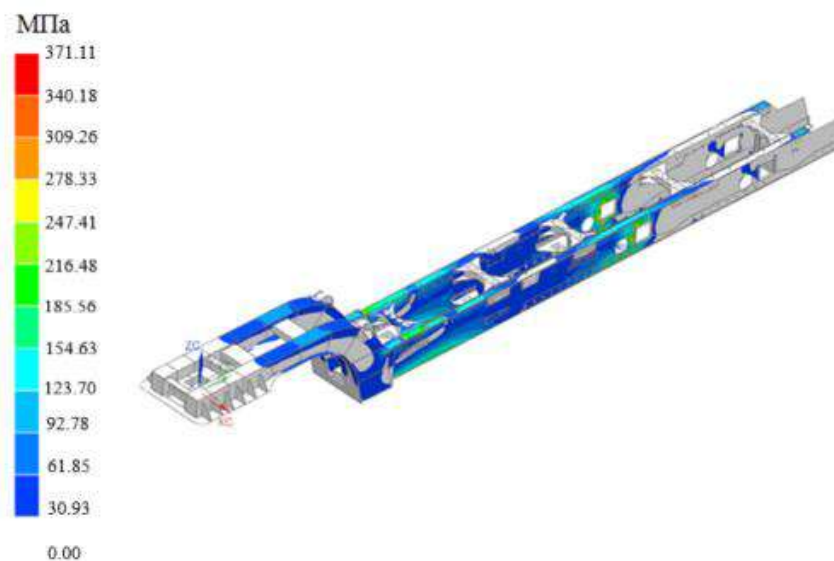
Рисунок 7.20 – Распределение эквивалентных напряжений в несущей раме (режим I)
