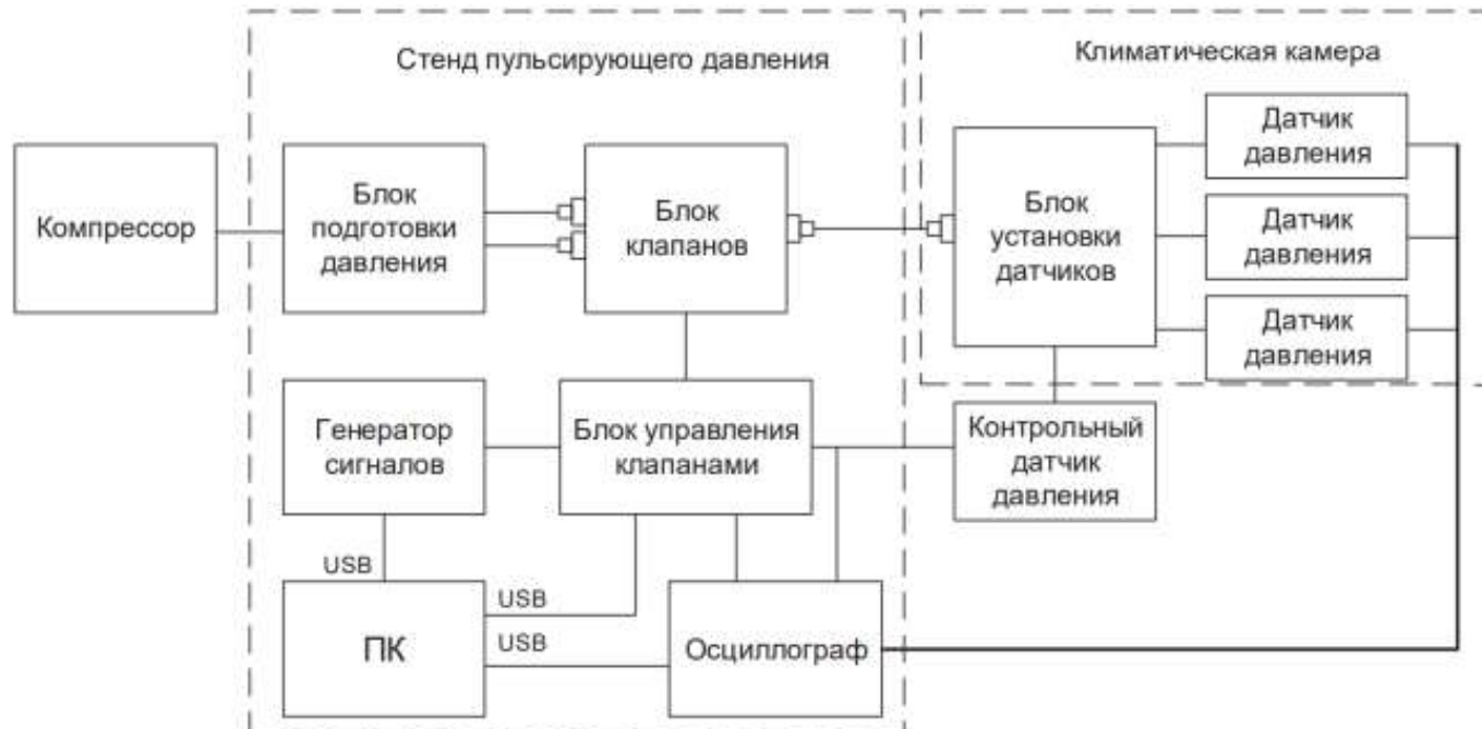
Рис. 53: Схема соединения оборудования.
