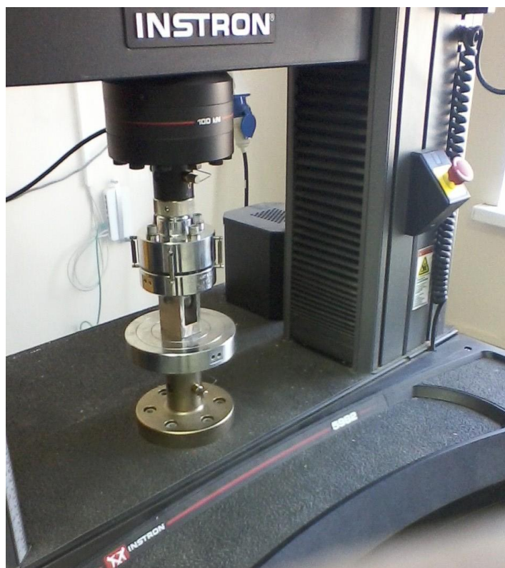
Рисунок 5.5 - Экспериментальное определение деформации элементов планетарной передачи
