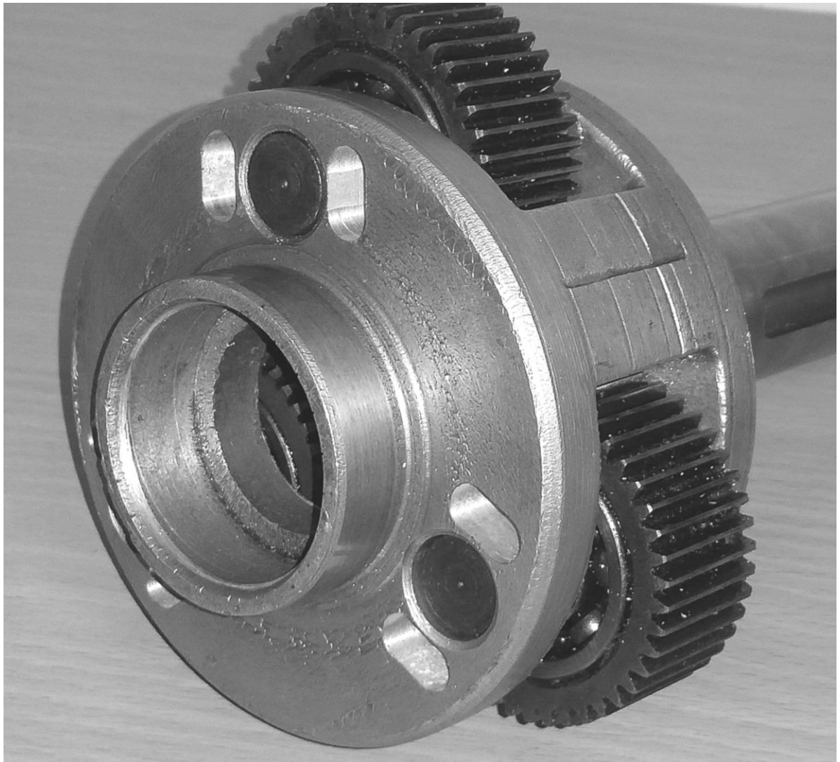
Рисунок 5.13 - Опытный образец планетарной передачи с податливым водилом
