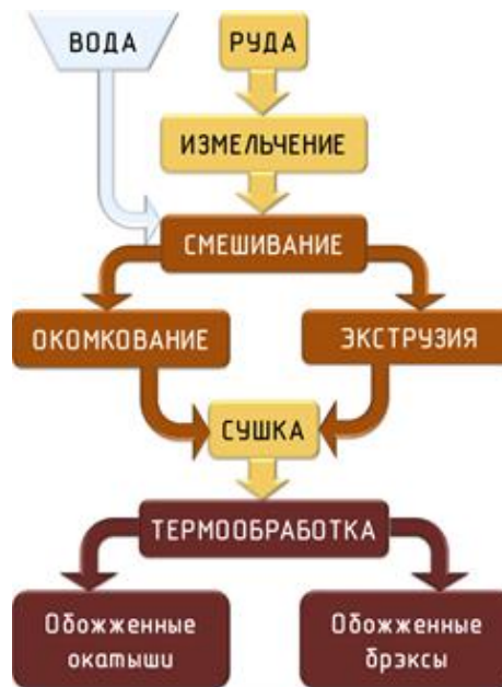
Рис. 4.1 – Схема изготовления окатышей и брикетов экструзии (брэксов).
