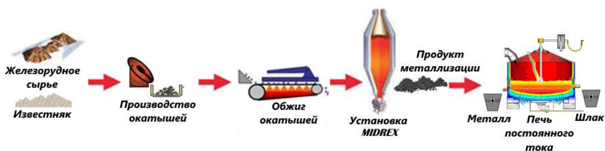
Рисунок 5.12 – Схема совмещения процессов восстановления в шахтной печи и разделения продуктов металлизации в электропечи постоянного тока.
