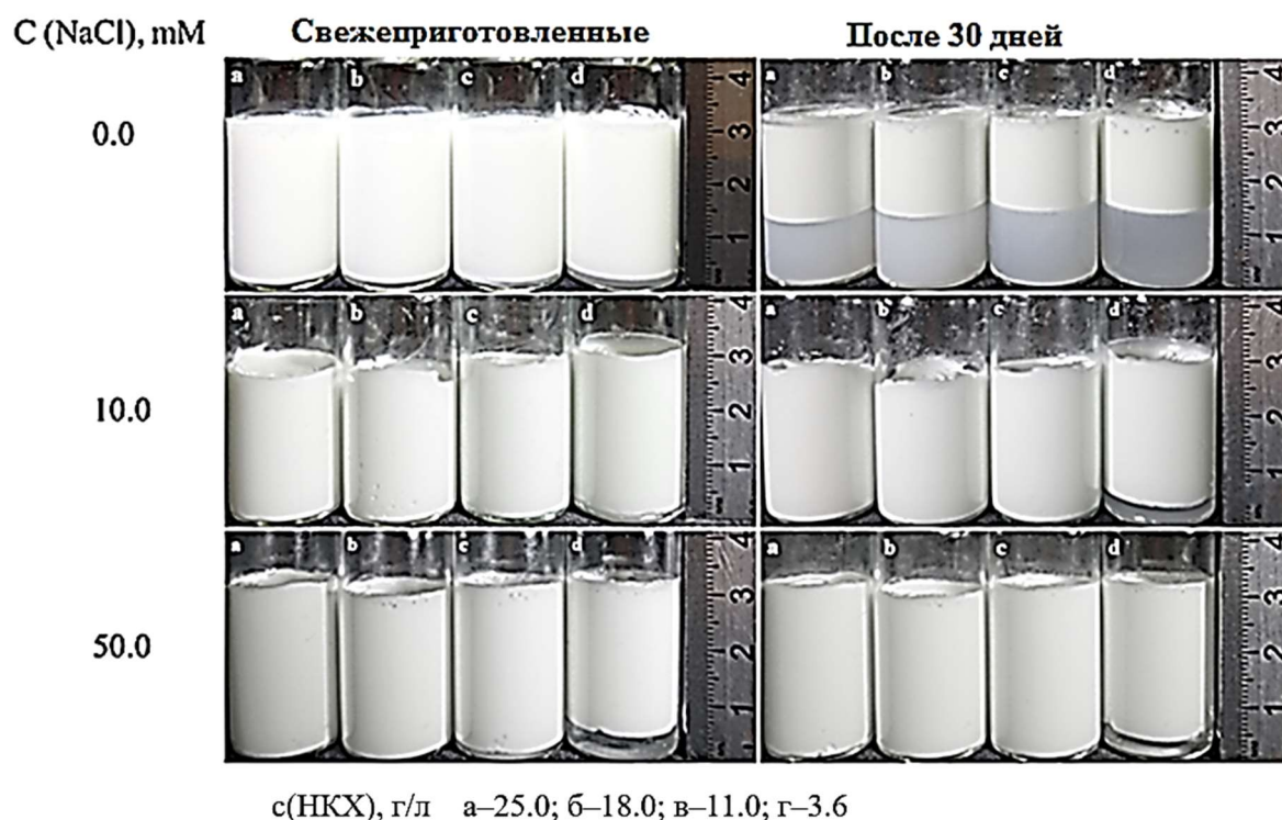
Рисунок 183. Оптические фотографии образцов эмульсии Пикеринга (30 об. % оливкового масла), стабилизированной НКХ, в зависимости от его содержания и концентрации NaCl.
