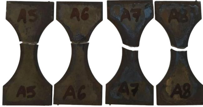
Рис. 4.11. Характерное место разрушения образцов из второго набора
