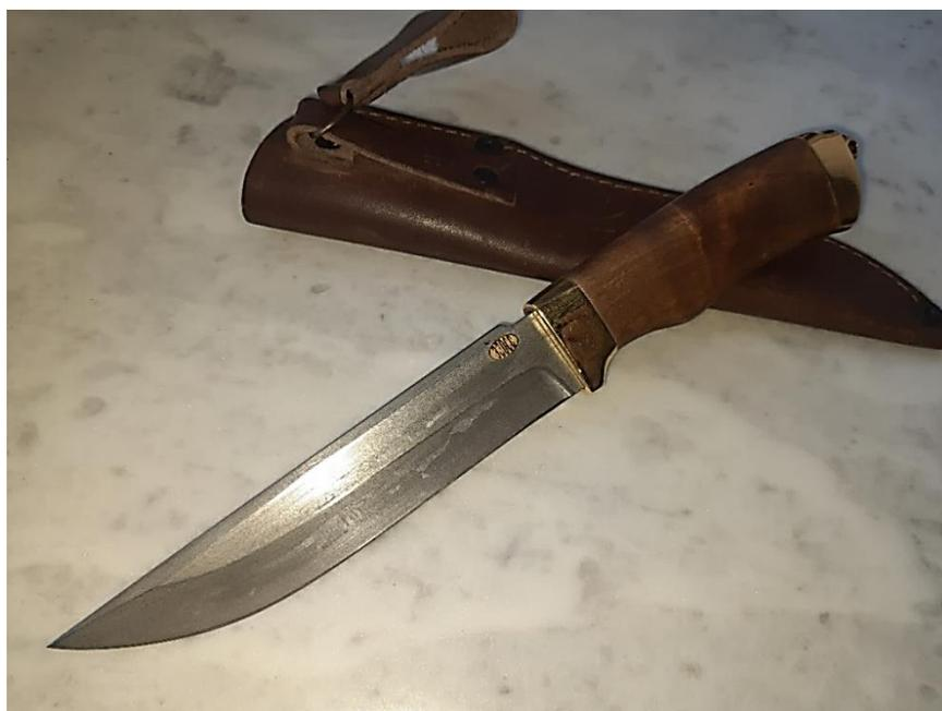
Рис. 4.13. Лезвие ножа, изготовленное из многослойной заготовки, полученной методом электрошлакового переплава
