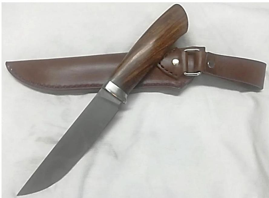
Рис. 4.14. Лезвие ножа, изготовленное из многослойной заготовки, полученной методом электрошлакового переплава
