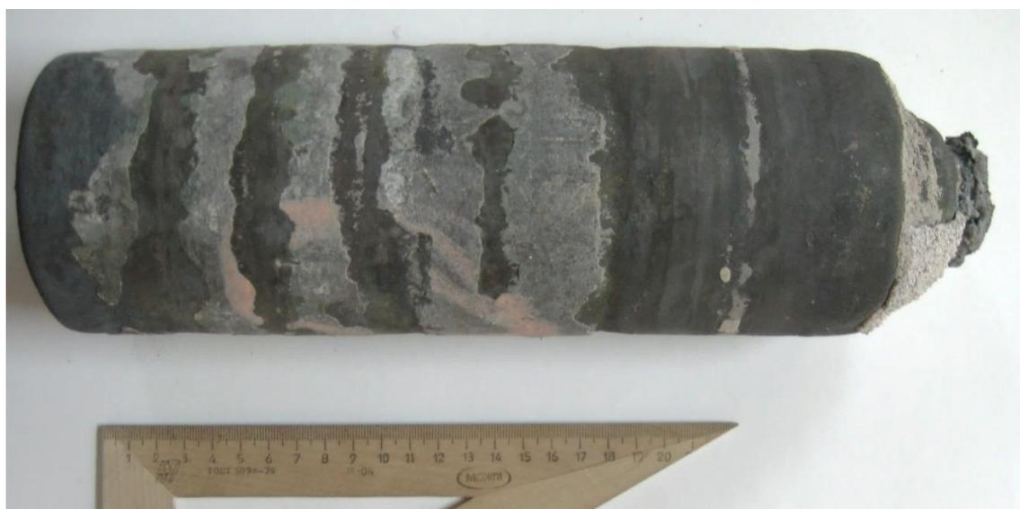
Рис. 4.4 Многослойный слиток, полученный путём периодической присадки корректирующей присадки
