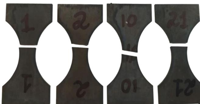
Рис. 4.10 Характерное место разрушения образцов из первого набора
