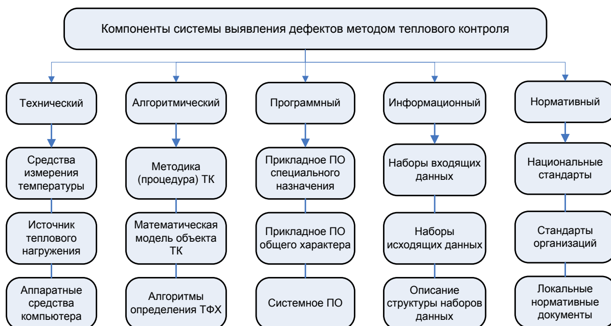
Рисунок 8 – Состав системы выявления дефектов методом теплового контроля
