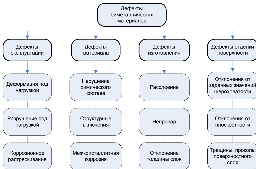
Рисунок 3 – Дефекты соединений биметаллических материалов (составлено автором на основе анализа литературы)
