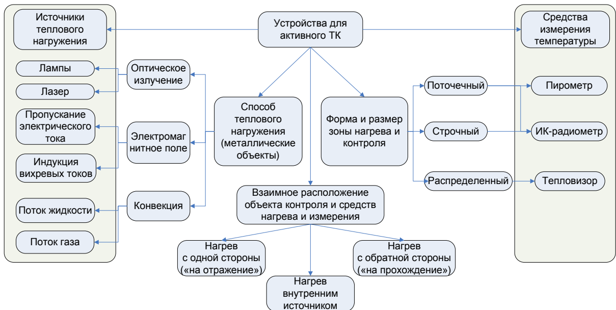
Рисунок 7 – Способы проведения активного теплового контроля
