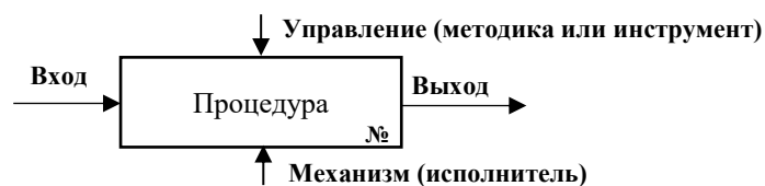
Рисунок 2.2 – Структура элемента графической нотации IDEF0 (составлено по [74])
