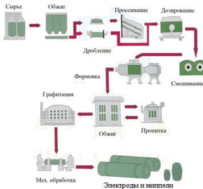
Рисунок 1.3 – Технологическая схема производства ГЭ [17]
