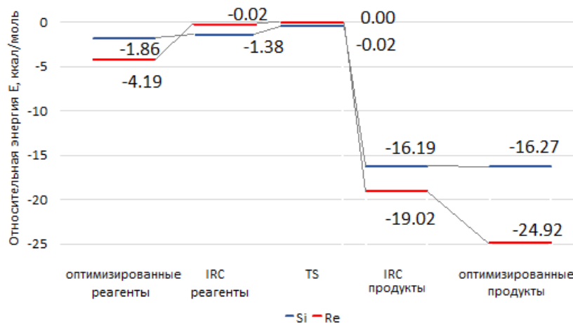
Рисунок 3.18 – Энергетические диаграммы путей реакции и сравнение энергии активации при разной ориентации хирального индуктора o - HP-O1-N + относительно бензальдегида
