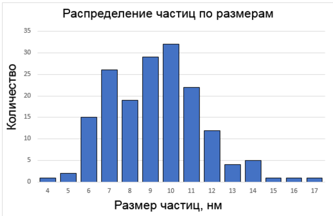
Рисунок 4.1-3 – Распределение по размерам частиц согласно данным ПЭМ
