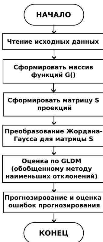
Рисунок 2.1. – Схема реализации модели
