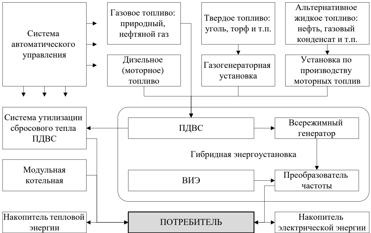
Рисунок 1.8 – Схема многофункционального энерготехнологического комплекса на базе ДВС с переменной частотой вращения
