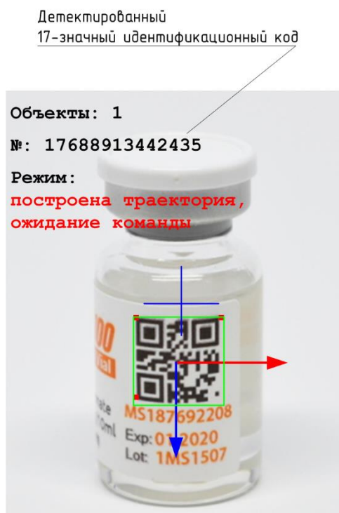
Рисунок 2.35 Вид объекта манипулирования и сопровождающей информации в окне вывода информации СТЗ
