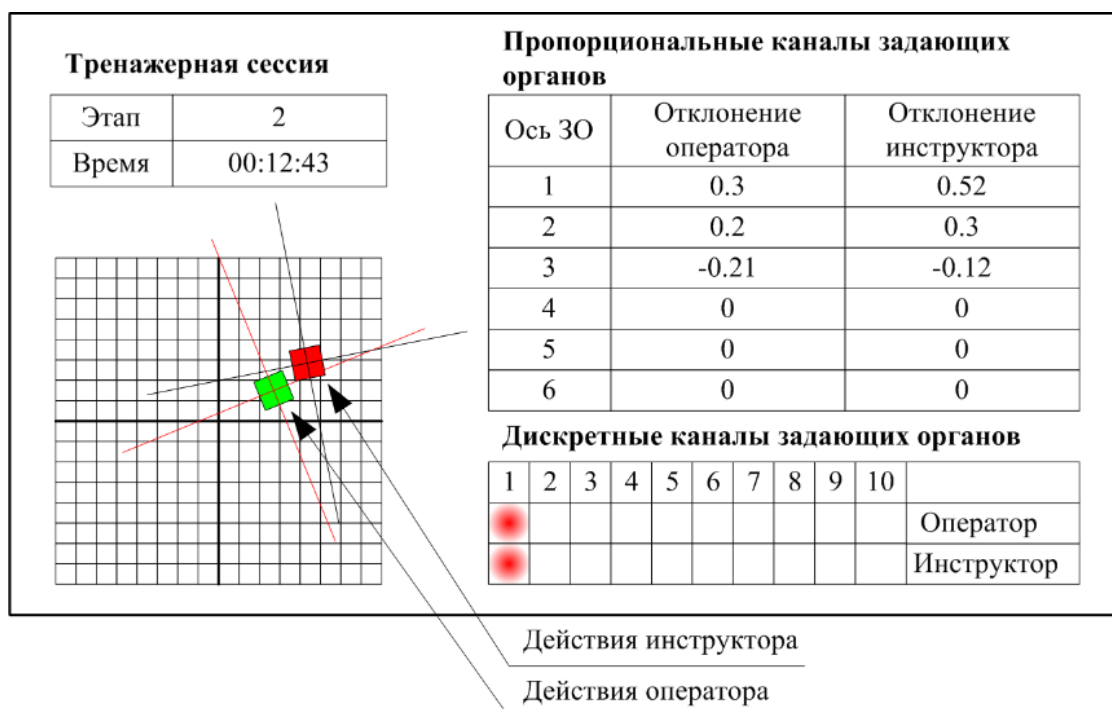
Рисунок 3.17 Окно контроля действий оператора и инструктора подсистемы визуализации информации
