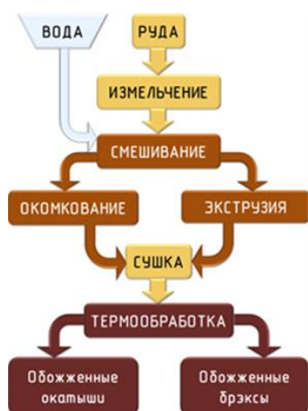
Рисунок 10 – Схема изготовления окатышей и брикетов экструзии (брэкссов).
