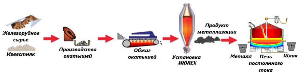
Рисунок 19 – Схема совмещения процессов восстановления в шахтной печи и разделения продуктов металлизации в электропечи постоянного тока.
