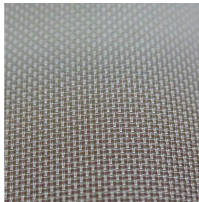
Рисунок 9 – Полиамидная ткань для фильтров грубой очистки с размером ячейки 400 мкм
