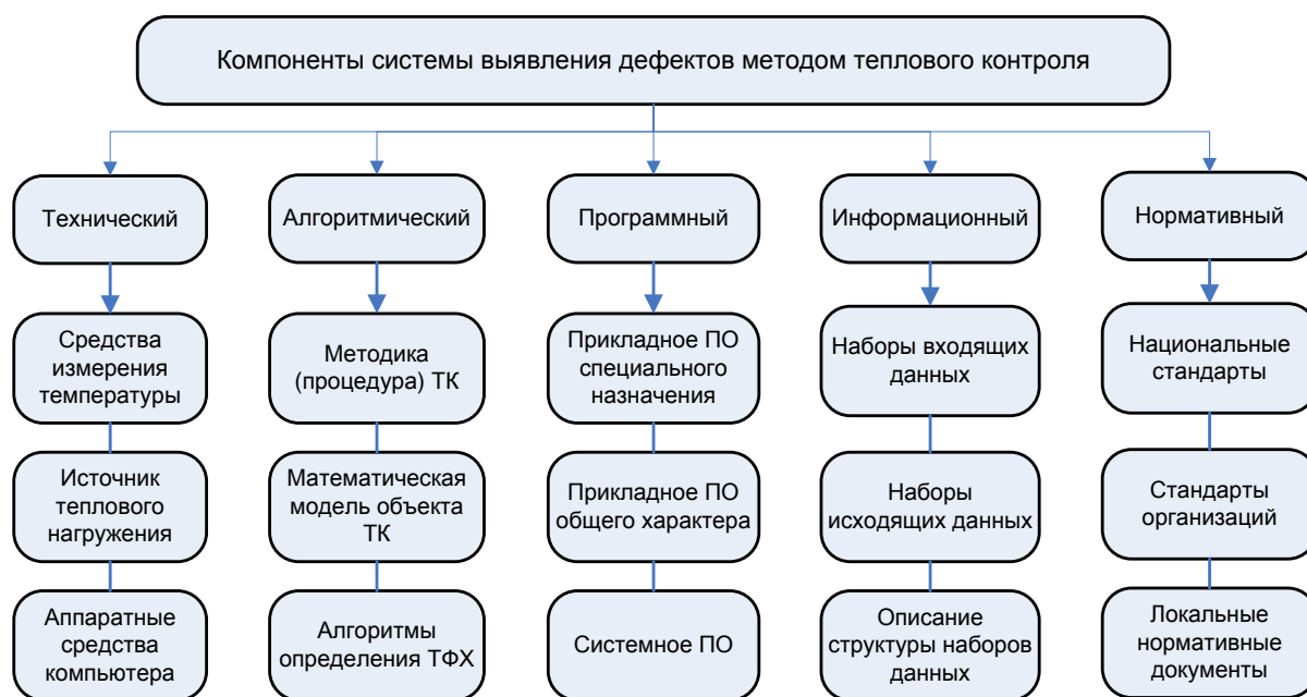
Рис. 2. Состав системы выявления дефектов методом теплового контроля
