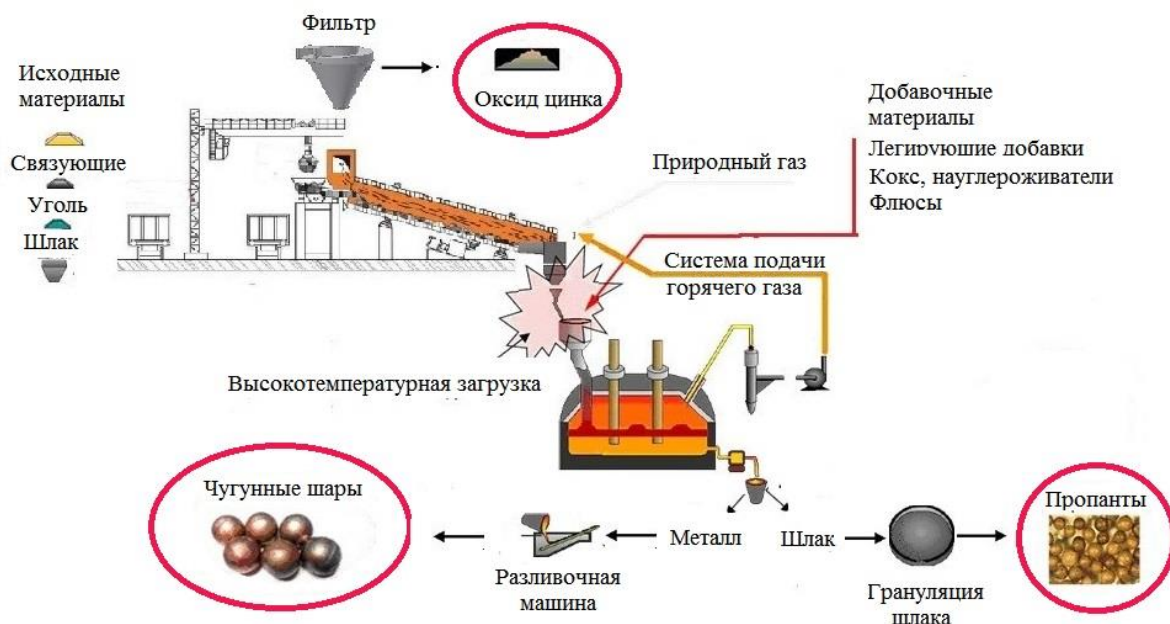
Рисунок 16 – Технологическая схема утилизации медеплавильного шлака.
