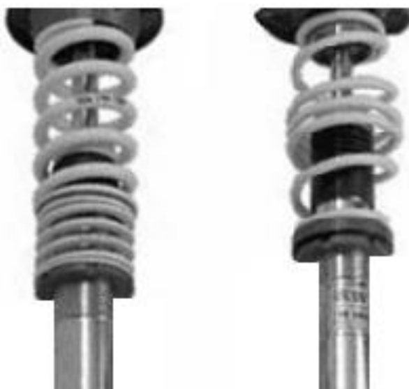
Рис. 2.37. Примеры выполнения пружинных подвесок автомобиля переменной жесткости
