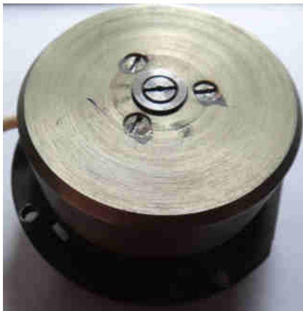
Рисунок 5.6 – Фотография синхронного электродвигателя ДБ–72_40_1000 с возбуждением от постоянных магнитов
