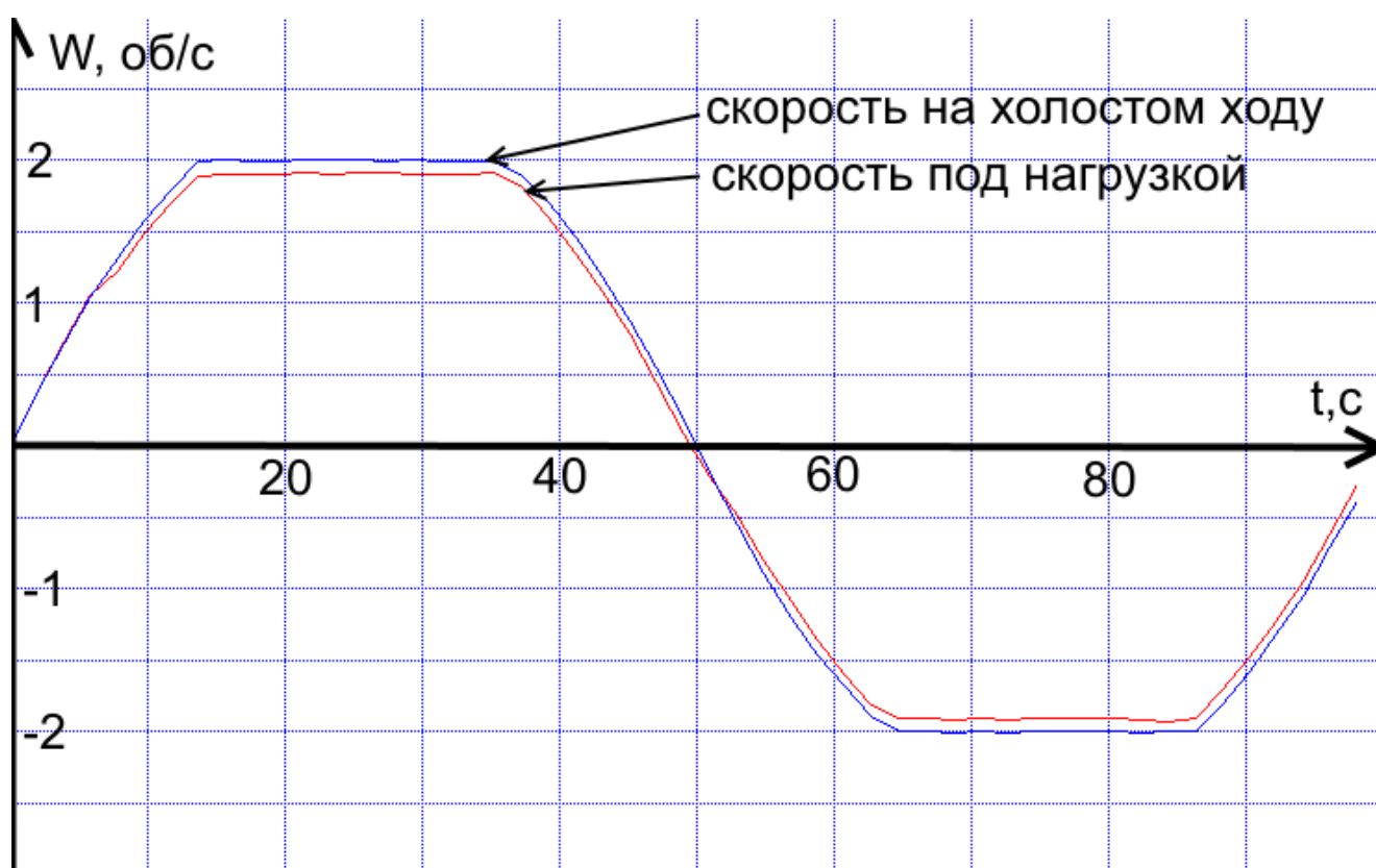
Рисунок 5.10 – Осциллограмма скорости вращения вала синхронного двигателя в бездатчиковом режиме, при использовании дискретного фильтра инвариантного погружения. Значения получены путем их фиксации фототахометром DT3334B.
