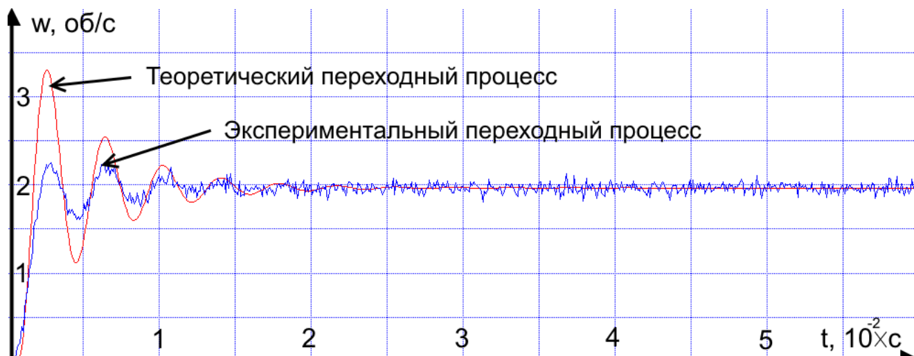
Рисунок 5.11 – Осциллограмма скорости вращения ротора ДБ–72_40_1000, при прямом пуске с постоянным моментом сопротивления в 0.5 Нм.
