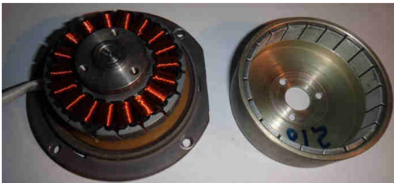
Рисунок 5.7 – Фотография синхронного электродвигателя ДБ–72_40_1000 с возбуждением от постоянных магнитов со снятым ротором
