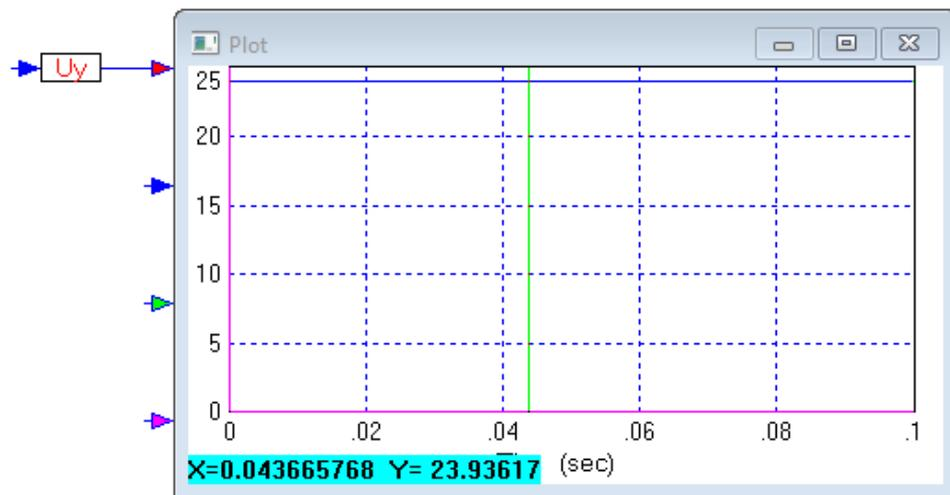
Рисунок 2.27 – График напряжения питания ( $U_n = 23.9$  В)
