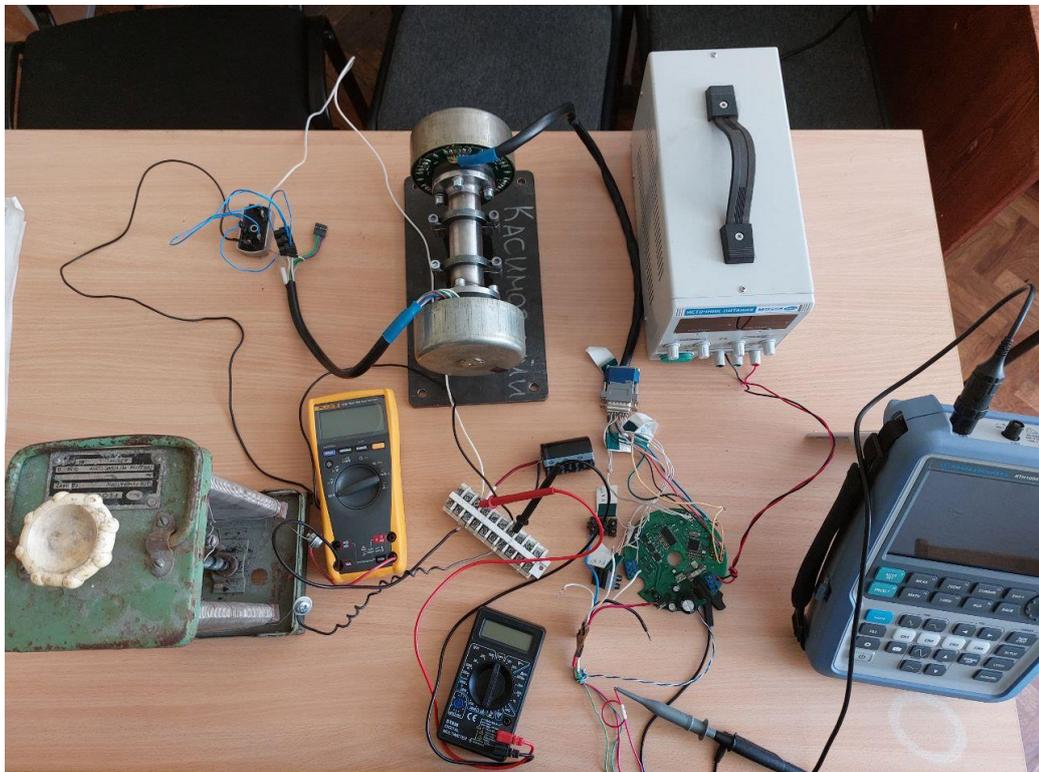
Рисунок 5.6 – Универсальный стенд для исследования ВЭП с ДК
