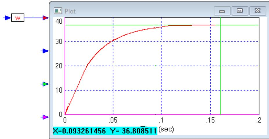
Рисунок 2.28 – График частоты вращения ( $\omega = 38,51$  рад/с)
