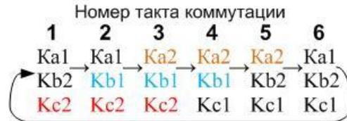
Рисунок 2.3 - Последовательность переключения силовых ключей при 180-градусной коммутации
