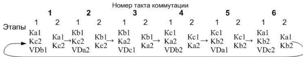
Рисунок 2.7 – Последовательность переключения силовых ключей и обратных диодов при шеститактной 120-градусной комбинации
