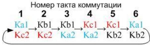
Рисунок 2.5. Последовательность переключения силовых ключей при шеститактной 120-градусной комбинации
