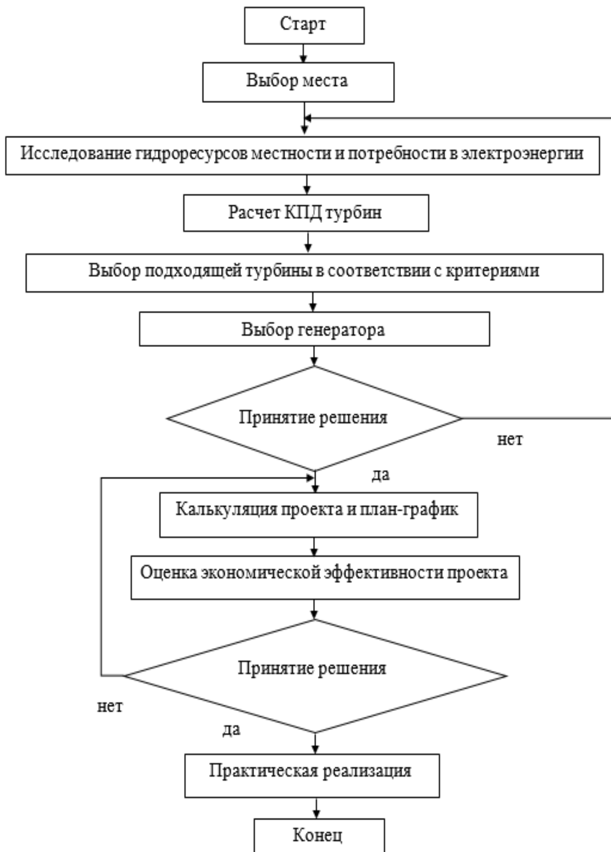
Рисунок 9– Структурная схема реализации проекта МГЭС
