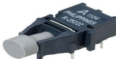
Рисунок 58 – Оптоволоконный приемник HFBR-2522
