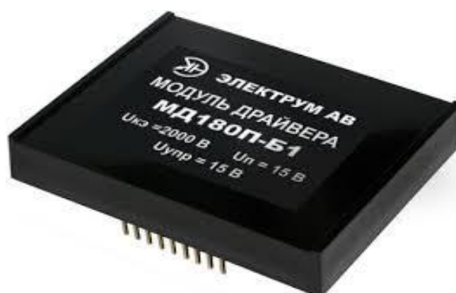
Рисунок 57 – Модуль драйвера МД180П-Б1
