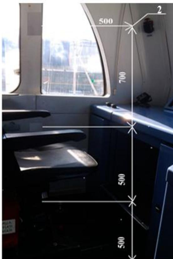
Рисунок 1.12 – Рабочее место помощника машиниста в кабине ЭП-2К
