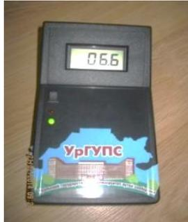
Рисунок 5.14 – Индикатор магнитного поля 50 Гц [43]
