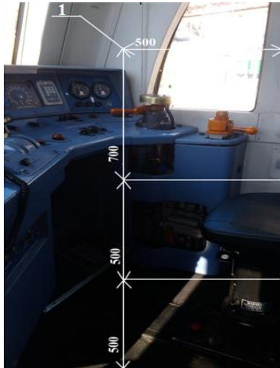
Рисунок 1.7 – Рабочее место машиниста в кабине ЭП-2К
